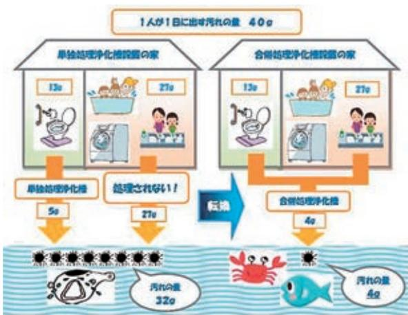
単独処理浄化槽を合併処理浄化槽にかえると、河川や湖に出る汚れの量を、約1/8に減らすことができます。
