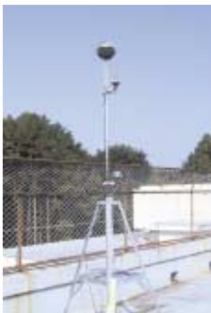
防衛施設庁によって設置されている騒音測定器(大和田地内)
