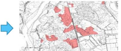
宅地造成前の写真または旧版地形図と宅地造成後の現況地形データの新旧のデータをコンピュータ上で重ね合わせ、造成後の高さや勾配、面積がガイドラインに該当する大規模盛土造成地を抽出しています。
