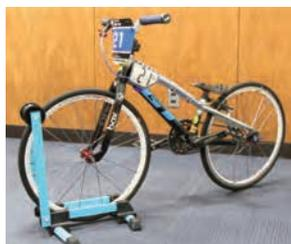
BMXでは、競技時の衝撃に耐えられる強度を持ち、スピードが出やすいように各パーツが軽量化された自転車を使用します。
